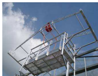
Figuur 6 Gebruik een servicedok om de dekkar van kap naar kap te verplaatsen
